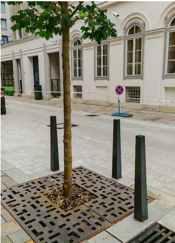
24. fotó: Pollerrel történő törzsvédelem, Budapest, V.
